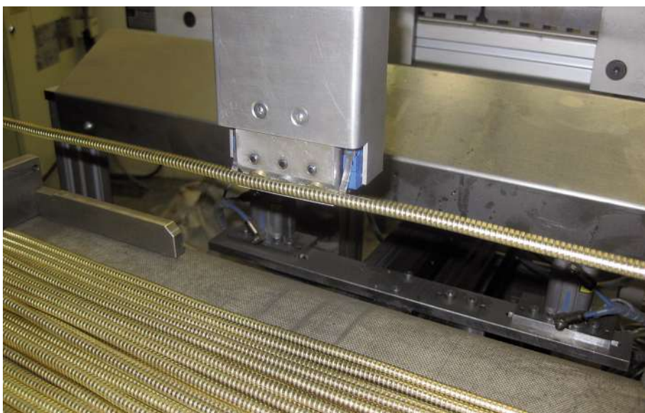
Dieser Greifarm hebt Wellen einzeln vom Zuführband. Dazu ist er mit Neodym-Stabgreifermagneten (Polyschuhsystem) ausgestattet. Die hohe Haftkraft wird erst bei direktem Formschluss erzeugt.
